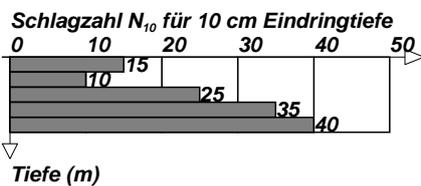
**Zeichnerische Darstellung von Bohrprofilen nach DIN 4023**
