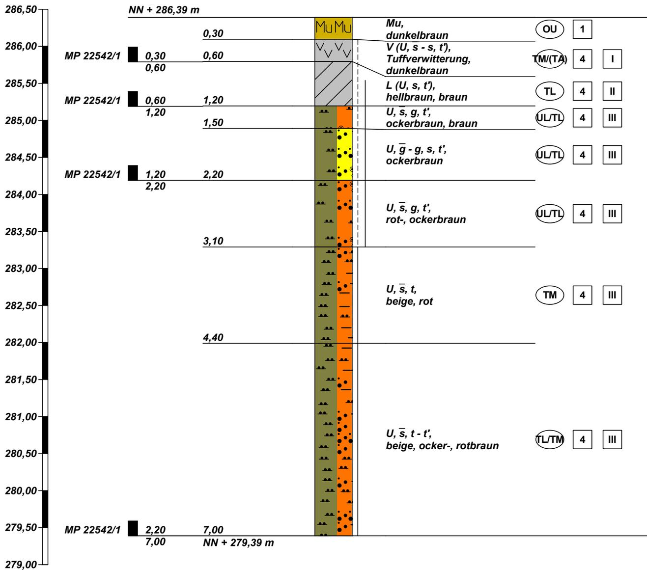
**Zeichnerische Darstellung von Bohrprofilen nach DIN 4023**
