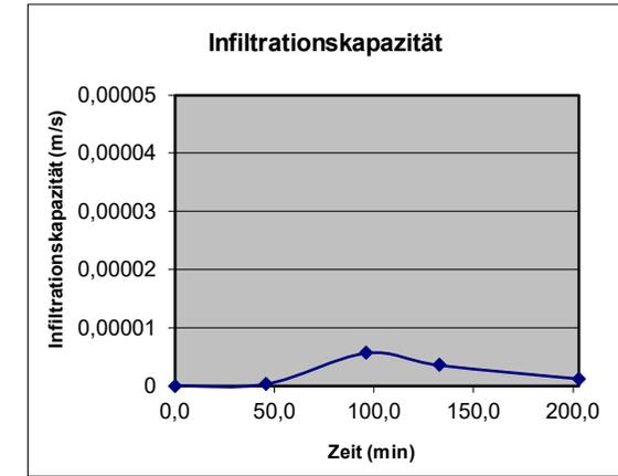
Feldgesättigte hydraulische Leitfähigkeit = 1,2E-06 m/s
